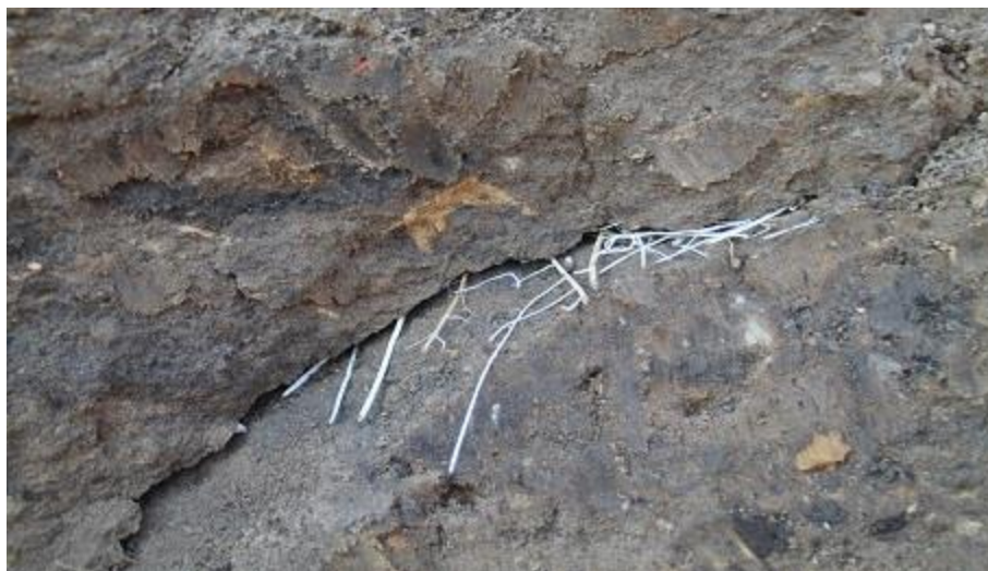
Figuur 2 Scheurvorming door TFI-methode
